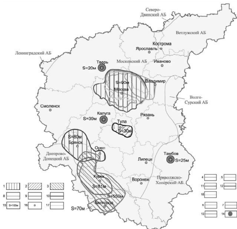
Рис. 3. Расположение региональных воронок депрессии на территории Центрального федерального округа: 1–14 — области интенсивного отбора подземных вод и расположения региональных (локальных) депрессионных воронок с учетом их перекрытия; 15 — глубина региональных воронок депрессии; 16 — областные центры; 17 — границы гидрогеологических структур [2].
